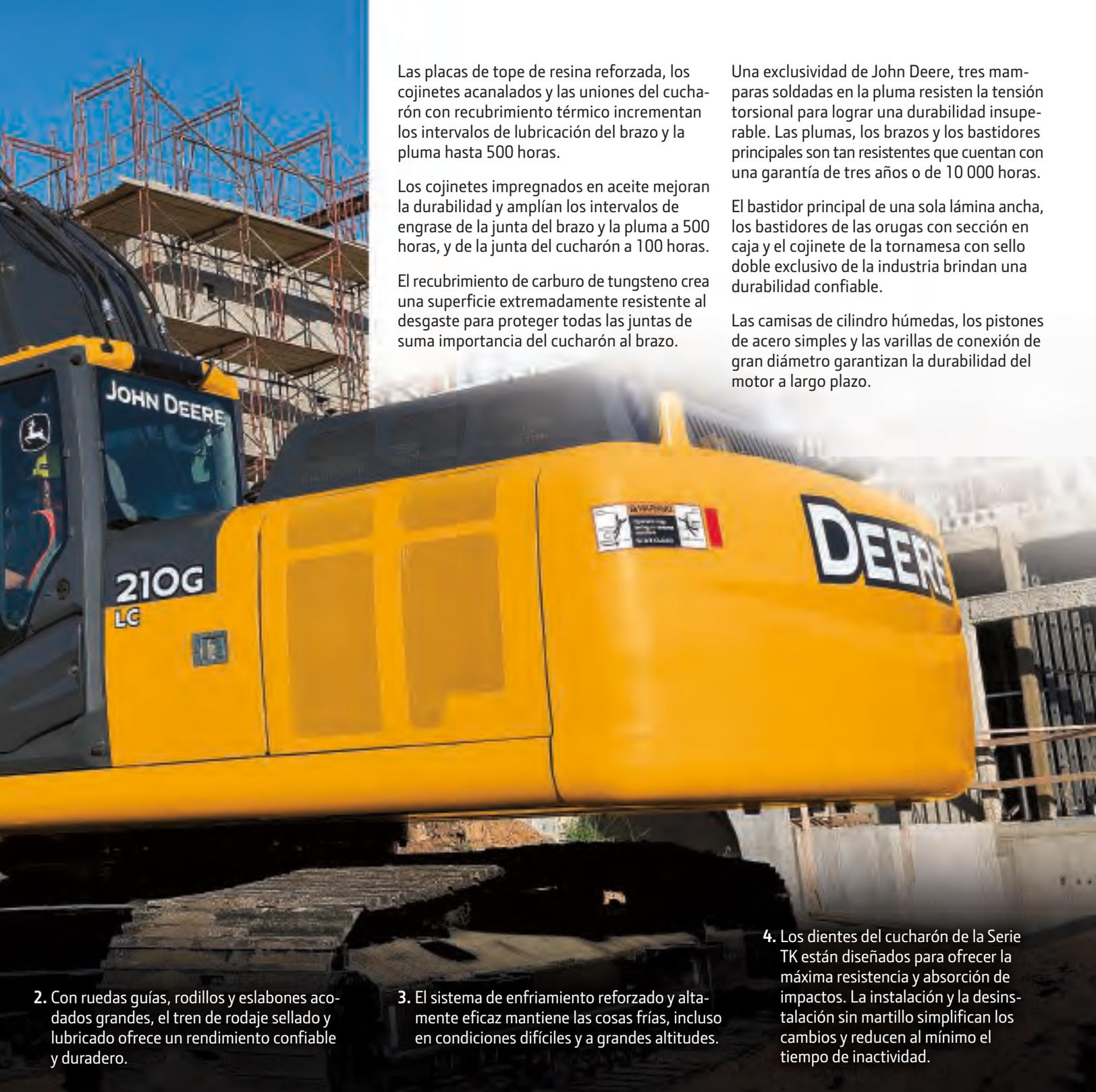
Las placas de tope de resina reforzada, los cojinetes acanalados y las uniones del cucharón con recubrimiento térmico incrementan los intervalos de lubricación del brazo y la pluma hasta 500 horas.
